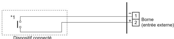
\*1 : Le commutateur peut être utilisé sur la condition suivante : 12 V à 24 V c.c., 1 mA à 15 mA.
